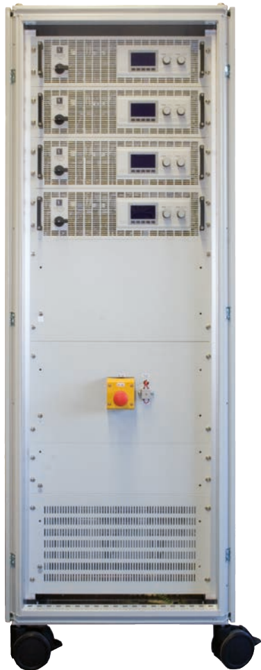
33HE-Schrank auf Rollen mit Not-Aus und 4x PSI 9000 3U / 33U cabinet on wheels, with emergency off and 4x PSI 9000 3U
